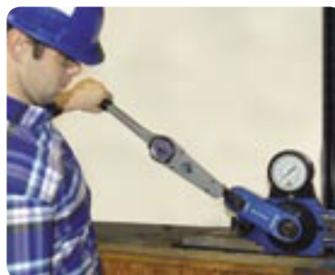
配套使用 Missing Link 系列增扭器及手动扭力扳手
