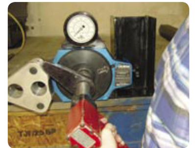
配套使用加长反作用力臂及气动增扭器
